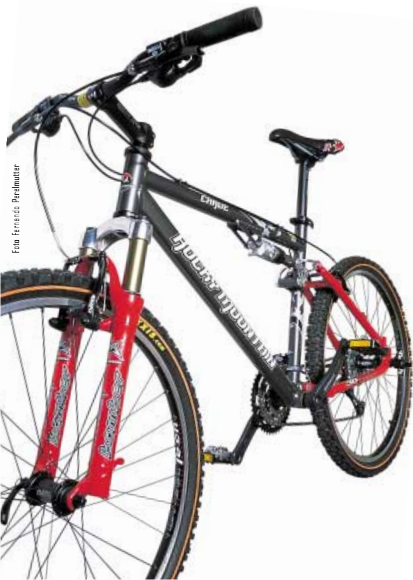
À esquerda, modelo Carve, para Cross Country. Produzido pela canadense Rocky Mountain, possui “full suspension” e quadro em alumínio; pesa apenas 12 quilos. No pé da página ao lado, modelo Octane, produzido pela norte-americana Scott. Para Free Ride, possui “full suspension” (dois amortecedores: dianteiro e traseiro) e freio a disco (mais eficiente). Reforçada, possui quadro em alumínio com dupla espessura e pesa cerca de 14 quilos
