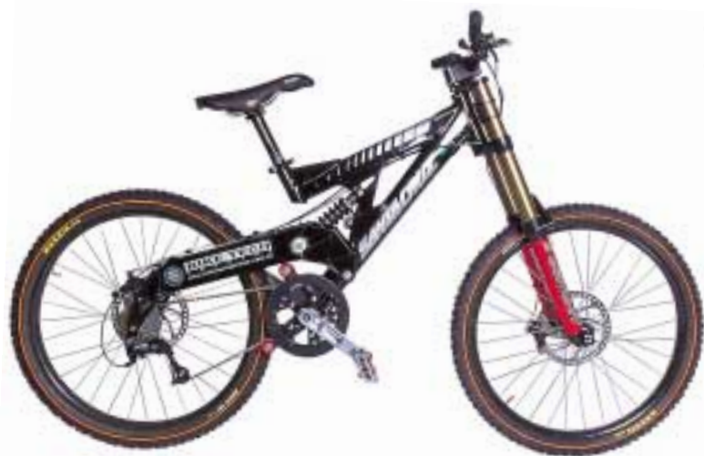
Acima, modelo Super 8, para Downhill. Produzido pela empresa californiana Santa Cruz, possui quadro reforçado em alumínio; um verdadeiro “tanque”: pesa 23 quilos. À direita, detalhe da suspensão
